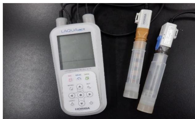
図 2 ガラス電極式水素イオン濃度指示計
