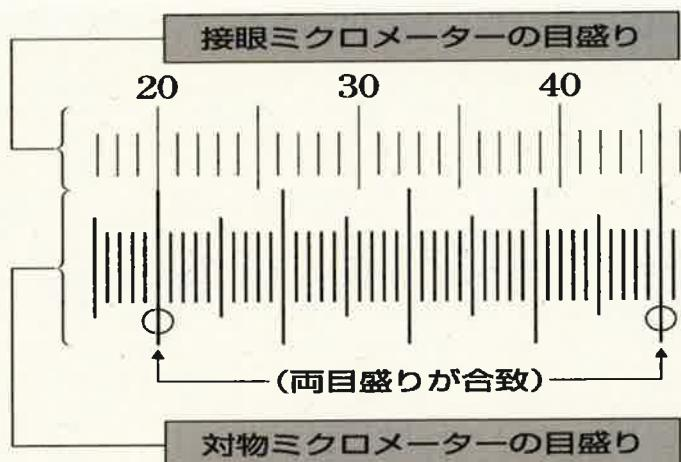
$$\text{接眼ミクロメーターの } 1\text{ 目盛りの長さ } (\mu\text{m}) = \frac{\text{対物ミクロメーターの目盛り数} \times 10\mu\text{m}}{\text{接眼ミクロメーターの目盛り数}}$$
